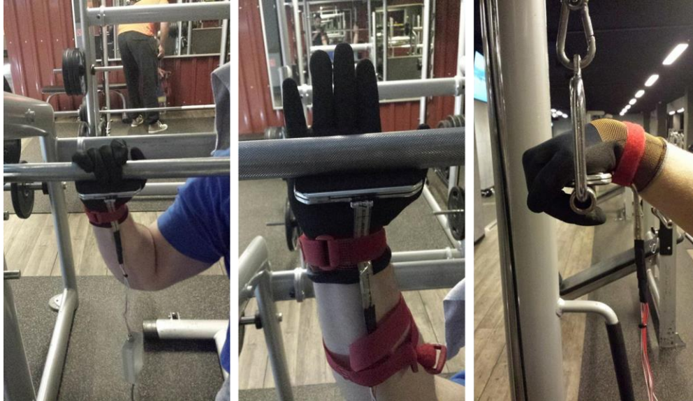
Abb. 1: Erprobung des Kraftsensors bei verschiedenen Krafrichtungen
