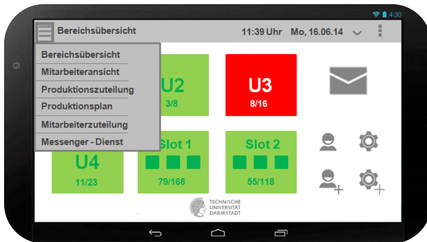
Abbildung 2: Hauptbildschirm Clickdummy mit geöffnetem Menü und Fehlermeldung in Linie U3
