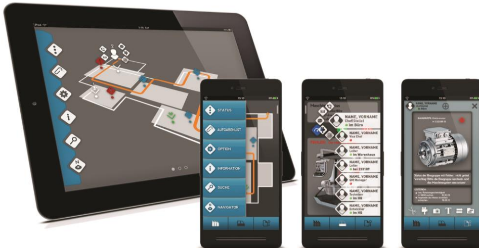
Abbildung 2: Darstellungen einer assistiven Bedienoberfläche zur Steuerung von Industrieanlagen (Xu & Kunack 2015).
